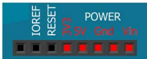
Εικόνα 12: Ακροδέκτες τροφοδοσίας
