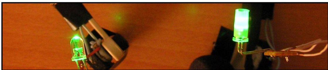
Εικ. 3.4 Επάνω: Η κάθετη τοποθέτηση της φωτοδιόδου και η διαφορά στην φωτεινότητα με την χρήση του ημιδιαφανούς περιβλήματος. Κάτω: Μετά την εφαρμογή της ρύθμισης χρωματικών επιπέδων
